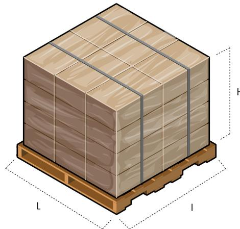
$$\left[ \begin{array}{l} \text{Poids volumétrique} \\ \text{en kilogrammes} \end{array} \right] = \frac{L \times I \times H}{5\,000}$$
